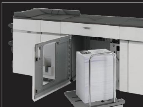
Los apiladores de 5,000 hojas opcionales con carritos rodantes. Pueden conectarse en tándem para salida sin supervisión de hasta 10,000 hojas.
